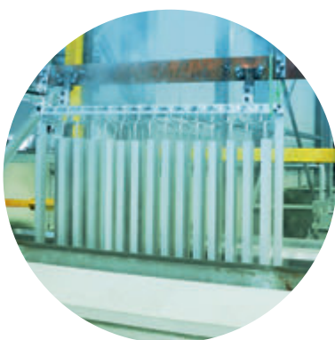
Galvanovňa RAVAK Eloxovanie hliníkových profilov - výroba najodolnejších profilov sprchovacích kútov, dverí a vaňových zásten.
