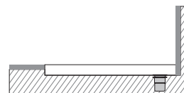
Padlóba süllyeszthető vagy padlóra ragasztható
